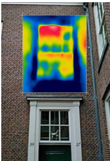
De thermografische opname van dit roederraam, na bezetting met isolerend glaslaminaat liet van buitenaf zien dat er extra warmte verdween via twee ruitjes van het bovenlicht. Binnen was het beeld omgekeerd: de twee ruitjes vertoonden een extra koud warmtebeeld. Hier waren door de glazenier twee ruiten per ongeluk met de reflectiecoating naar buiten geplaatst. Vanzelfsprekend is dit bij oplevering gecorrigeerd. Een klein led-detectortje ter plaatsbepaling van de IR-coating helpt bij goede plaatsing. © ejn
