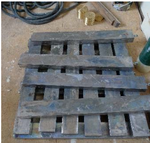
Links: nieuwe loden raamgewichten liggen klaar voor toepassing bij oude schuiframen die door bezetting met isolatieglas flink zwaarder zijn geworden. Op de achtergrond nieuwe messing poelies voor de raamkoorden. Rechts: UV-bestendig kunststofkoord dat visueel niet is te onderscheiden van klassiek hennepkoord. Daarmee zijn de schuifraamkoorden hoogwaardig uit te voeren. © ejn
